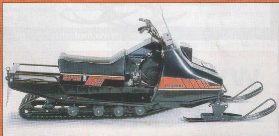
Ockelbo Poro, en liten och smidig långbandare med encylindrig 277 kubiks Rotaxmotor på runt 23 hästkrafter blev en försäljningsframgång för Ockelbo. En lappmoppe med fin framkomlighet i lössnö.
