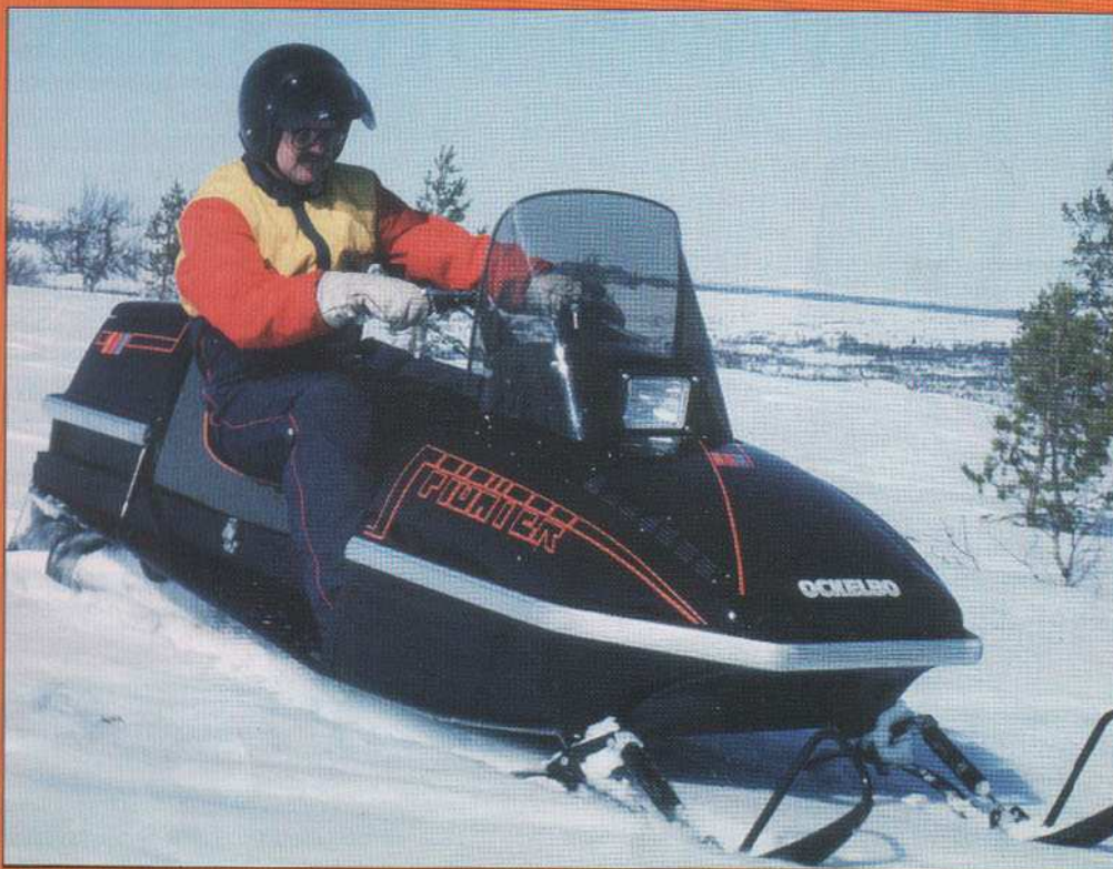
Ockelbo Fighter presenterades lagom till det kungliga besöket i Ockelbo inför säsongen 1987/1988. Fightern var tänkt som en ersättare till modell 5000 som succesivt fasades ut ur tillverkningen. Jämfört med 5000 var Fighter en helt ny konstruktion. Den var både längre, tyngre och starkare. Under huven på Fightern satt en 497 kubiks Rotax 503 som gav 43,5 hästkrafter. På bilden från våren 1987 är det Snowmobiles chefredaktör Jan Engström som provkör maskinen.
